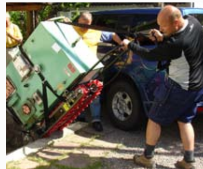
Elektriska trappklättrare upp till 1000 kg
